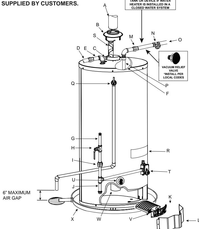
(T) GAS CONTROL VALVE/THERMOSTAT
